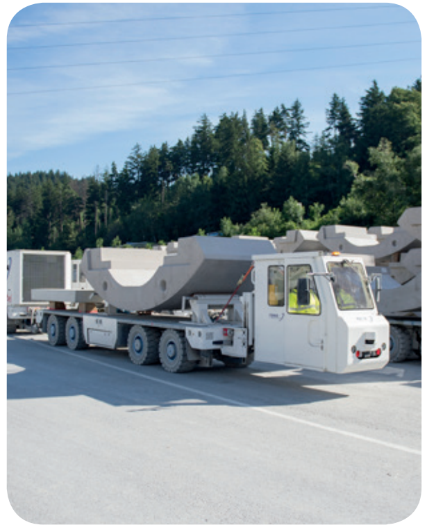
Das sogenannte „Multi Service Vehicle“ ist für die Versorgung der TBM im Erkundungsstollen Ahrental-Pfons zuständig.
