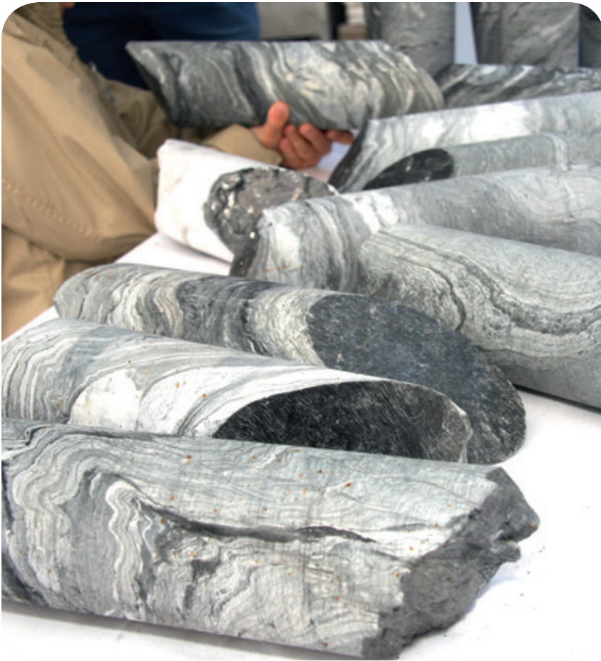
Diese Gesteinsproben sind das Ergebnis von Probebohrungen. Sie geben Aufschluss über die Beschaffenheit des Gebirges und bilden die Grundlage für bautechnische Maßnahmen.
